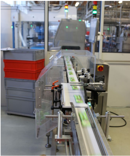
Fruchtriegel: Hintereinander in Höchstgeschwindigkeit über die Doppelwaage.
