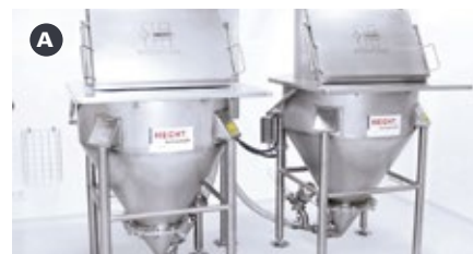
A: Sackeinschütten mit integriertem Sieb
