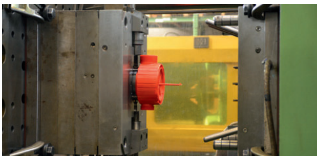
Eigene Spritzgussfertigung, hier für das Gehäuse eines FMC.
