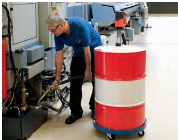
Befüllen einer Anlage mit Hydrauliköl (F 430 AL).
