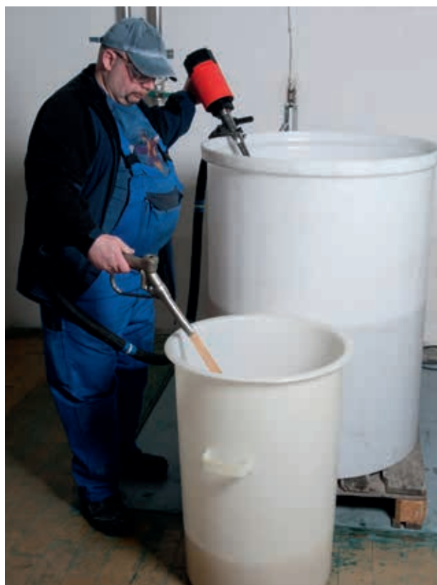
Einfach die Stellhebel umstellen und schon kann das Medium zügig gefördert werden.
