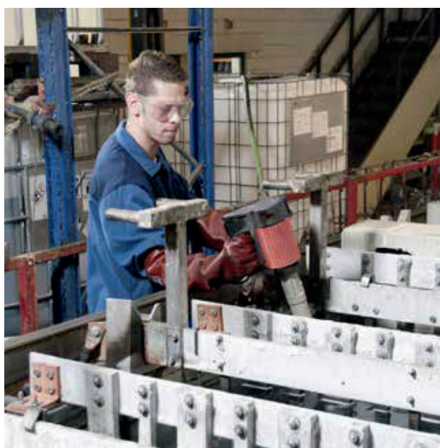
Entleerung eines Galvanikbeckens (F 424 PP).
