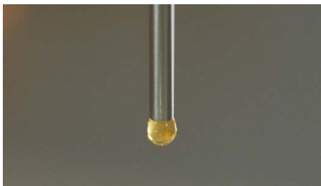
Dank eines programmierbaren Rückzugs am Ende jedes Dosierprozesses wird ein Nachtropfen verhindert.
